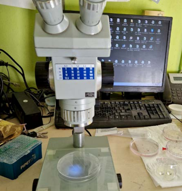
Binokulární lupa na vyhledávání a klasifikaci embryí z výplachu in vivo
